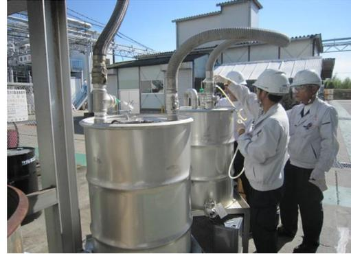
また、既設の脱臭装置からのさらなる臭気抑制のため、水(酸性・アルカリ性)、充填剤を使用した脱臭装置を設置し、効果をテストしています。
