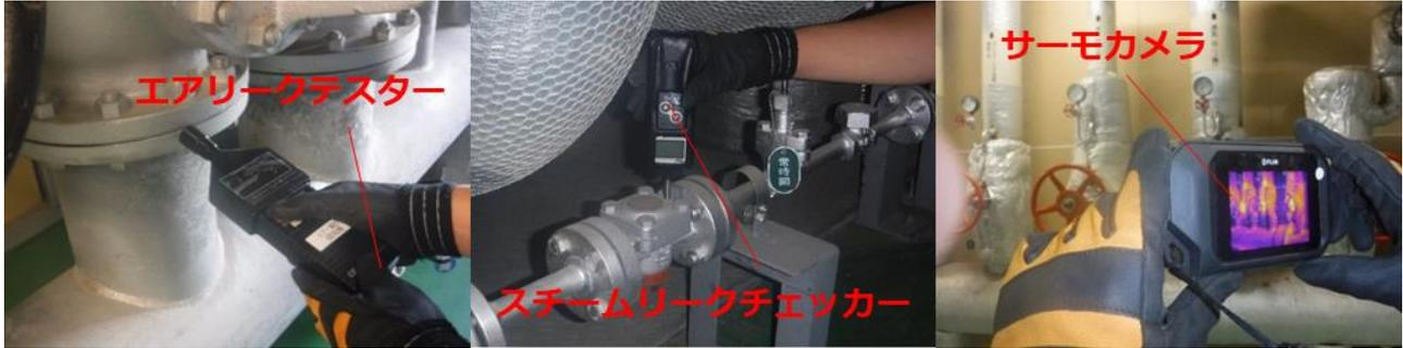
図. (左) エア漏れ、(中) 蒸気漏れ、(右) 断熱状態をチェックする調査ツール
