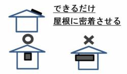
壁面の外縁部より外側に太陽光発 電設備等がはみ出ないようにする <u>最上部をできるだけ低くし、</u> <u>端部からできるだけ後退す</u>
